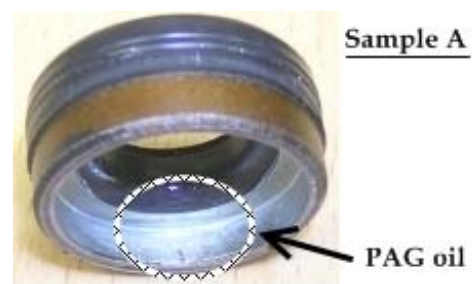
Figure 14 Présence d'huile du côté extérieur du joint tournant A qui montre la fuite d'huile à l'arrêt
