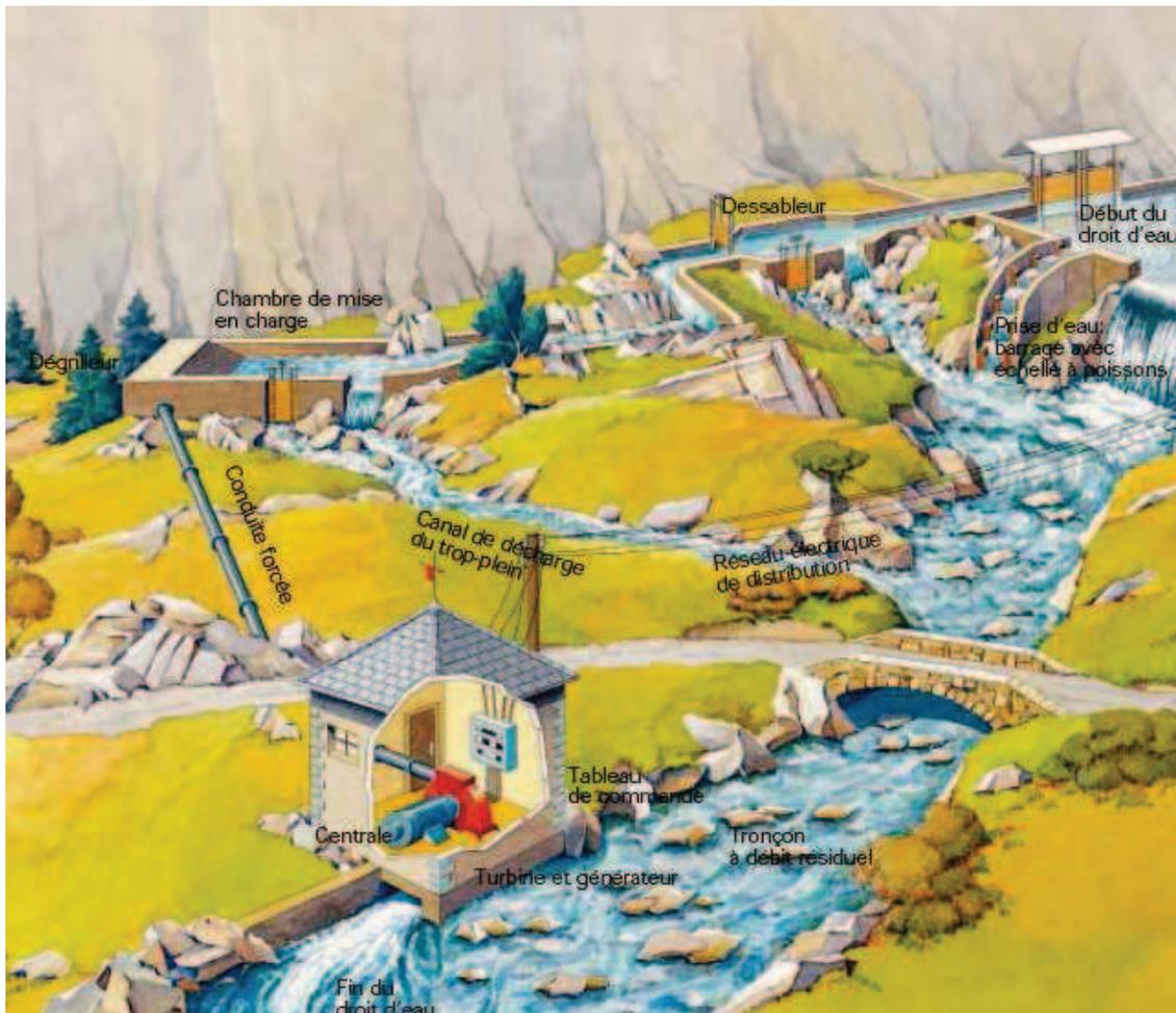
Fig. 1.3. Vue d'ensemble d'une centrale à haute pression sur canal de dérivation [10]
