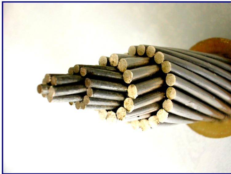
FIG. 4.3 – Coupe Cable Haute Tension
