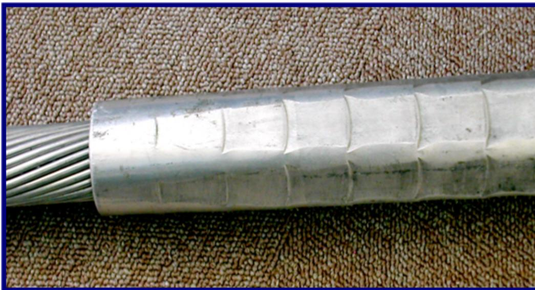
FIG. 4.4 – Manchon de Lignes Haute Tension
