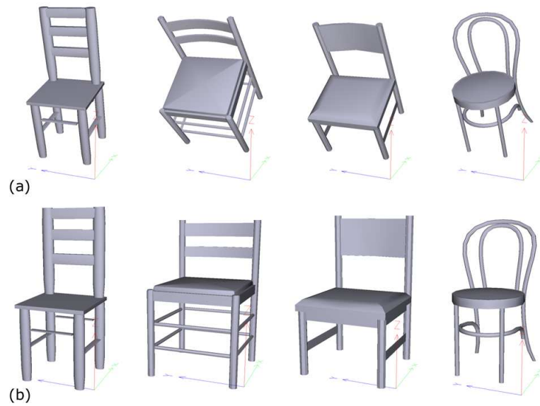
FIG. 3.12 – Alignement des modèles de la classe “chaise de cuisine” utilisant l’ACPC (a) et notre méthode (b).
