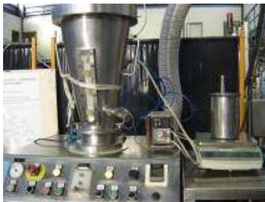
Figure 2.2.1. Pilote d'agglomération en lit fluidisé (Uni-Glatt) avec pulvérisation par le haut.
