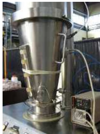
Figure 2.2.1. Pilote d'agglomération en lit fluidisé (Uni-Glatt) avec pulvérisation par le haut.
