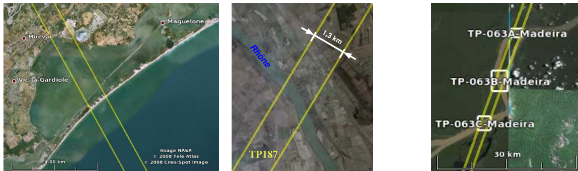
(a) Trace 146 du satellite Topex/Poseidon sur l'étang de Vic (Languedoc-Roussillon) (b) Largeur de la trace 187 de Topex/Poseidon sur le Rhône, au sud d'Arles (entre les limites Est et Ouest) (c) Stations virtuelles à l'intersection entre le fleuve Madeira (bassin amazonien) et la trace 63 de Topex/Poseidon
