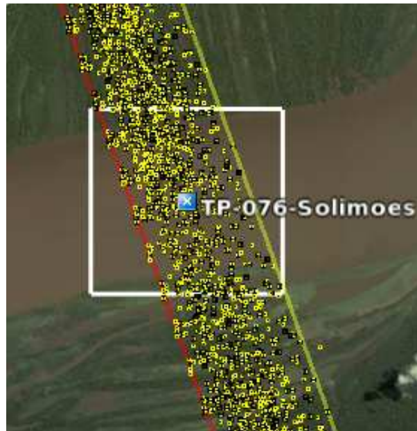
FIG. 3.4: Illustration d'une fenêtre géographique d'extraction sur le fleuve Solimões (Brésil) pour la station virtuelle « TP-076-Solimoes » : Accumulation des mesures à 10Hz obtenues par Topex/Poseidon sur la trace 76 de sa première première orbite (1993-2002). Les traits obliques de gauche et de droite représentent respectivement les limites Ouest et Est de la trace, extraites depuis quelques cycles. (Image GoogleEarth).
