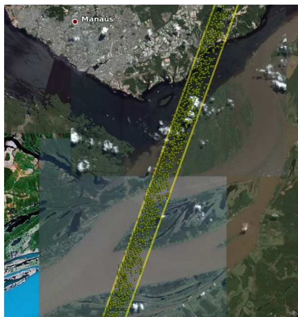
FIG. 2.3: Les mesures altimétriques à 10Hz (points jaunes) collectées par Topex/Poseidon sur la période 1992-2002 permettent de désigner les cycles dont les mesures sont les plus éloignées de la trace moyenne. L'assemblage de ces cycles (incomplets) permet d'obtenir deux cycles complets représentant les limites Est et Ouest des trace de Topex/Poseidon. L'exemple illustre ici les limites de la trace 63. (Image GoogleEarth).
