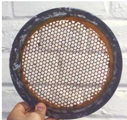
Figure II-3 : Grille utilisée pour générer de la cavitation
