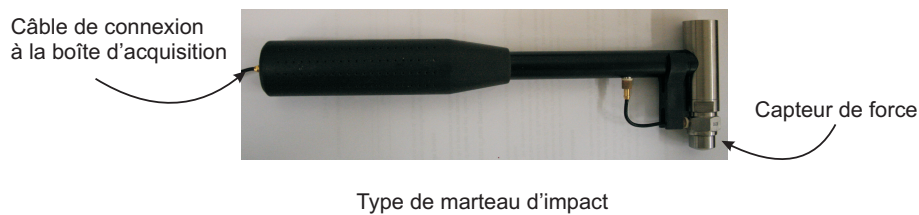
FIGURE IV.2. : Marteau utilisé pour la génération des vibrations
