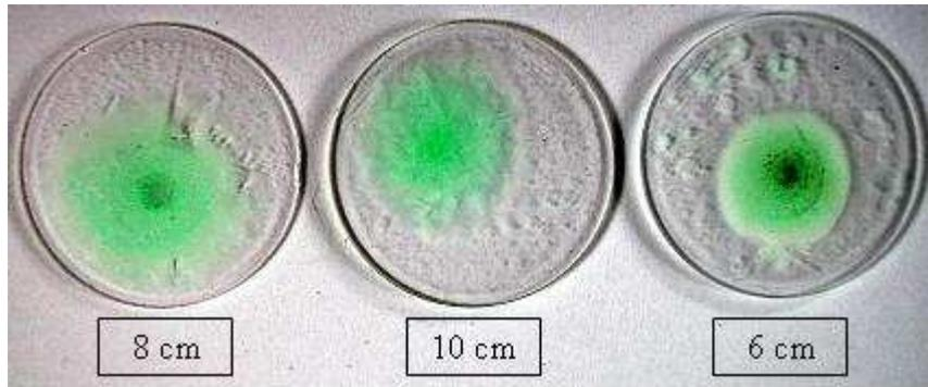
**Figure 18 : Photographie des dépôts réalisés à 15 W à partir des nitrates de Ni avec différentes distances tuyère-substrat**
