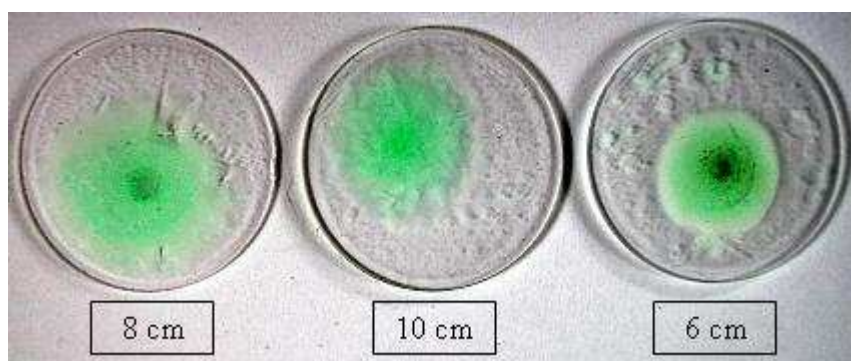
Figure 18 : Photographie des dépôts réalisés à 15 W à partir des nitrates de Ni avec différentes distances tuyère-substrat
