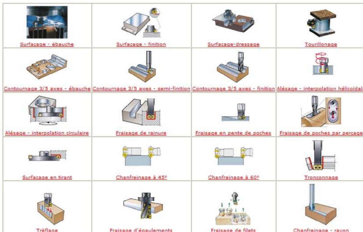
Figure VI.3. Exemple des opérations de fraisage [Sandvik, web].
