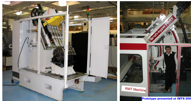
Figure I.11. Exemples de machine reconfigurable de mesure et d'usinage de culasses.
