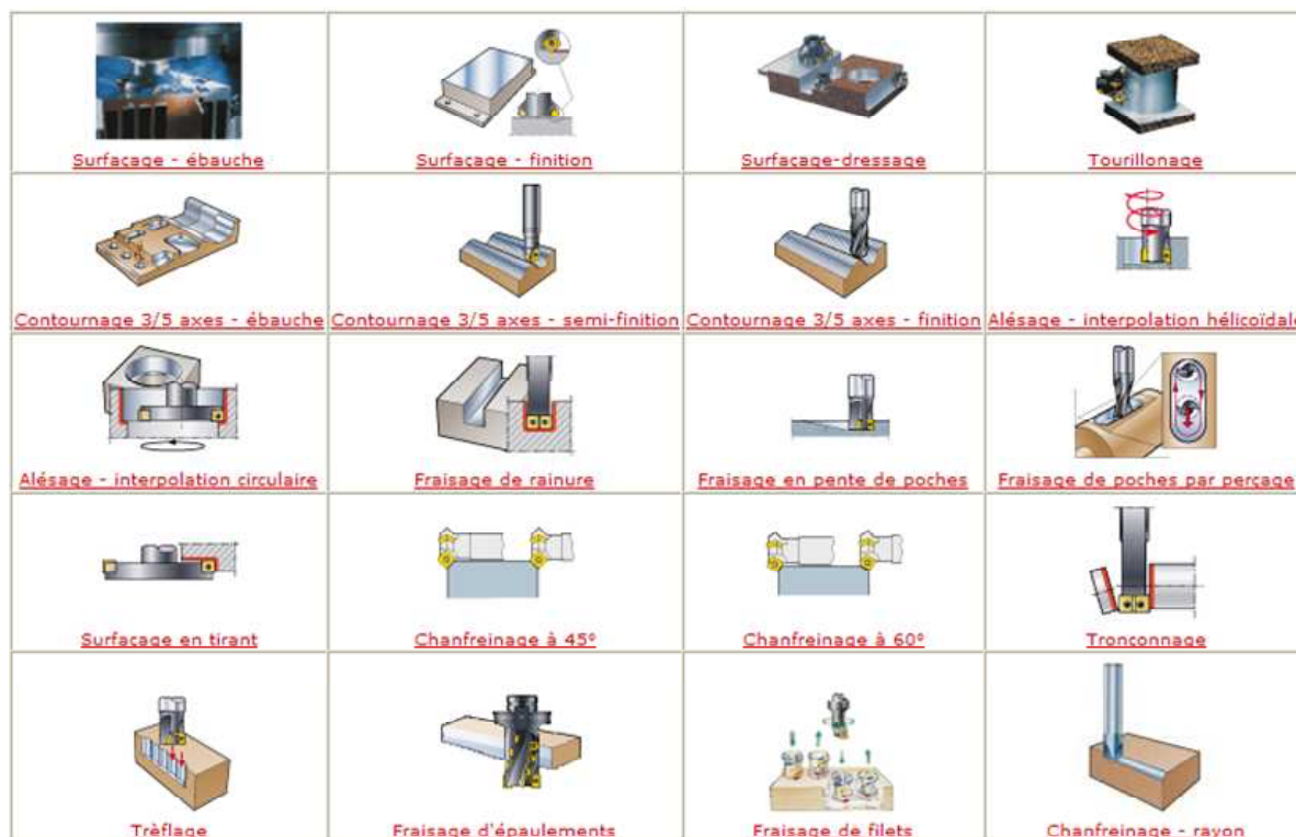
Figure VI.3. Exemple des opérations de fraisage [Sandvik, web].
