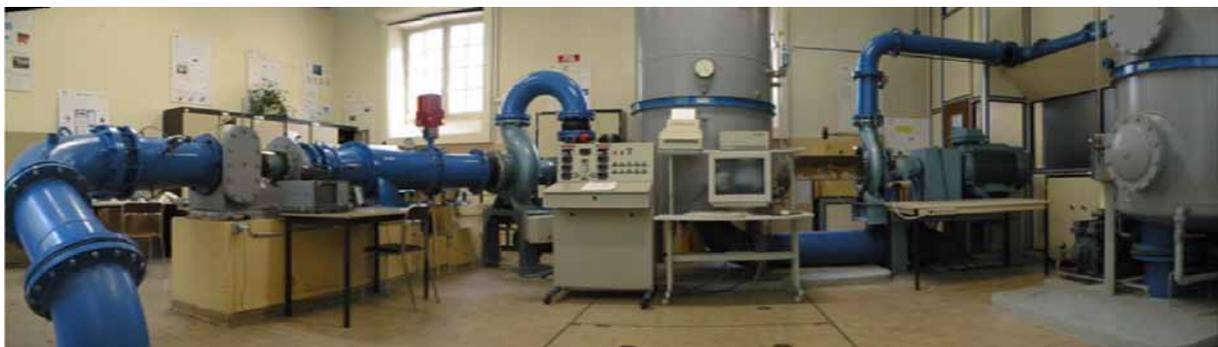
FIG. 4.5 – Banc d'essai hydrodynamique du LEMFI-Paris, *circuit D350*.
