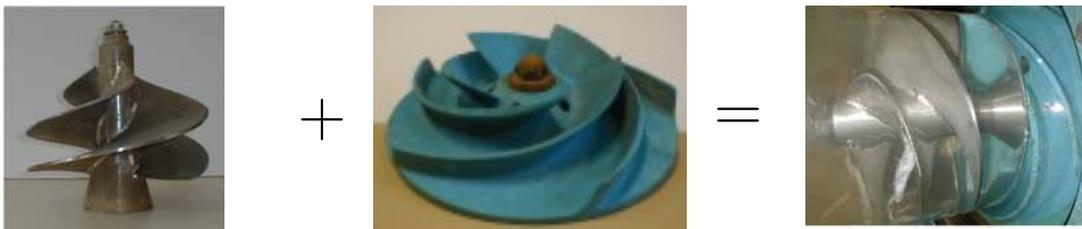
FIG. 1.9 – Couplage Pompe centrifuge-inducteur.
