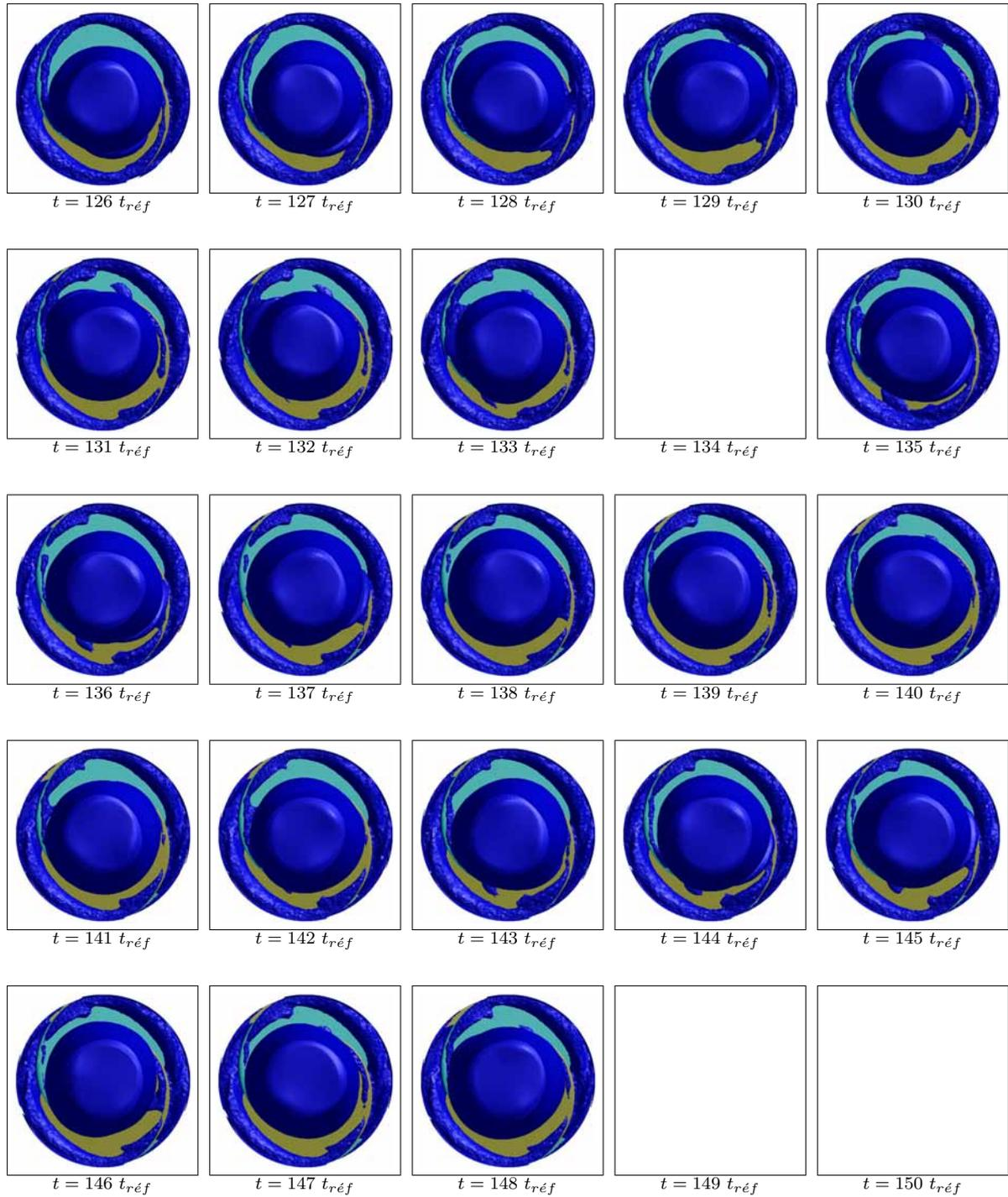
FIG. 5.36 – Evolution temporelle de la vapeur ( $\alpha = 20\%$ ) dans l'inducteur **A**, pour  $\Phi = 0,0050$  et  $\sigma = 0,064$ , vue de face.
