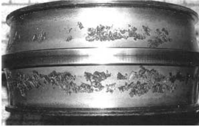
FIG. 1.10 – Exemple d'écailles sur une bague intérieure de roulement [47]
