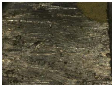
FIG. 1.11 – Exemple de scuffing sur une bague de roulement [49]
