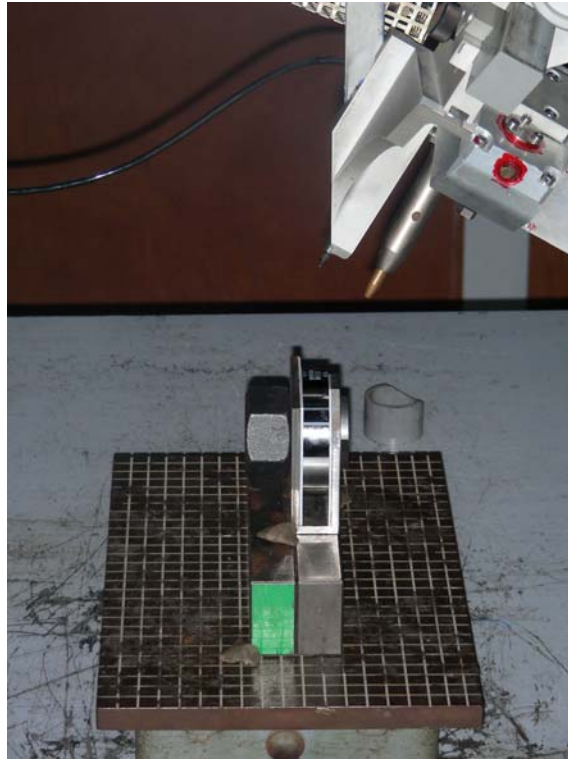
FIG. Q.1 – Positionnement du galet pour la mesure des contraintes résiduelles aux rayons X
