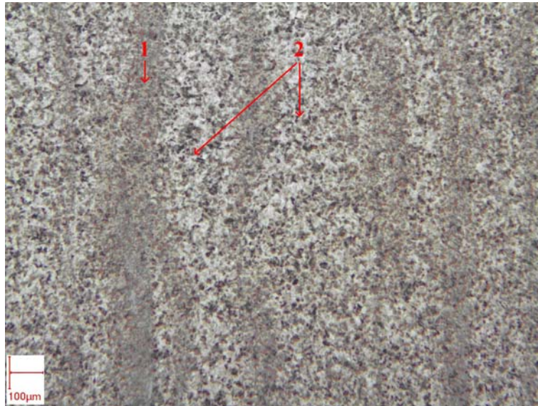
FIG. D.2 – Structure à coeur (attaque C1)
