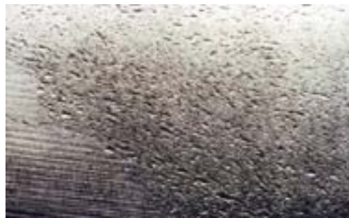
FIG. 1.9 – Exemple de micro-écaillage sur une dent de pignon [46]
