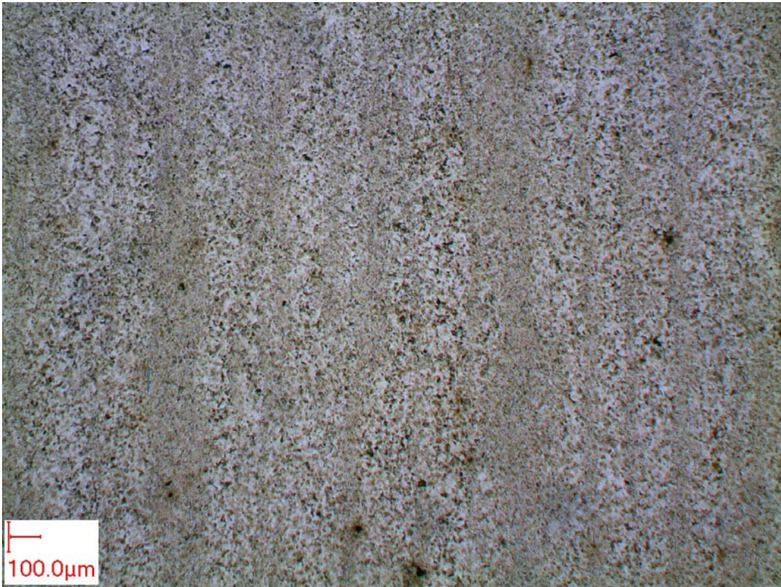
FIG. 2.2 – Structure de l'acier 100Cr6 trempé dans la masse à 170^{\circ}\text{C} (grossissement x 50)
