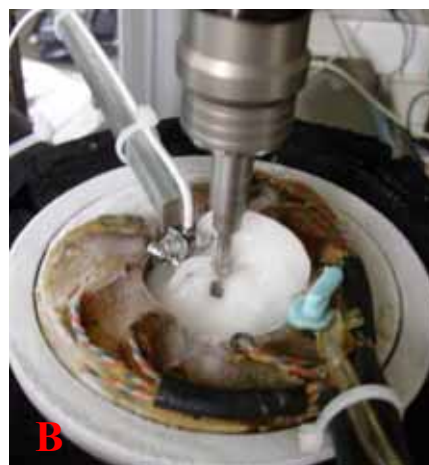
Figure III-14. Montée de la glace lors des essais avec les solutions à différentes concentrations de sucre : (A) 15% et (B) 45%.
