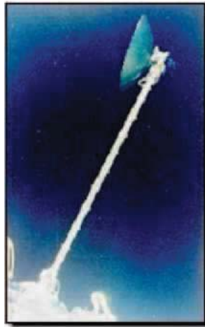
Figure 1.4 – Mât d’antenne du satellite Hubble 6061 / 40% fibres de carbone [4].
