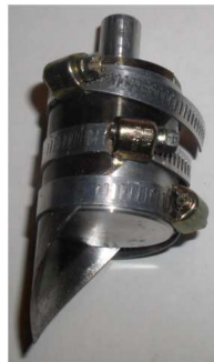
FIG. 1.30 – Scie "cloche" sans dent réalisée pour la découpe des échantillons cylindriques
