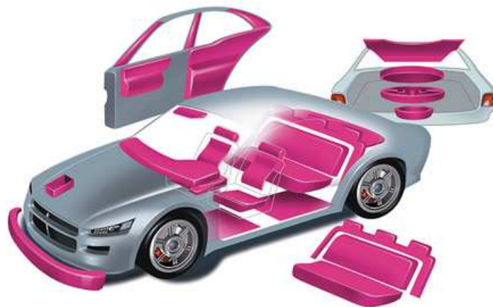
FIG. 1.2 – Exemples d'applications des matériaux cellulaires dans l'automobile : pare-chocs, assises, protections latérales, appuis-tête, etc. [Suffis, 2006]
