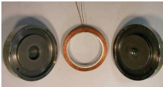
FIGURE 2.16 – Structure du frein-test et photographie des pièces avant la dernière étape de l'assemblage.
