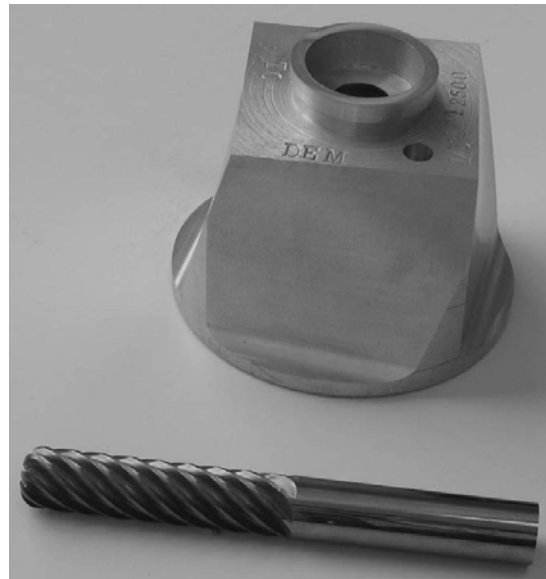
Figure IV.6 : Pièce test en alliage d'aluminium, avec son outil de forme optimisée.
