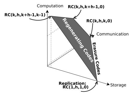
Figure A.10: Illustration du trade-off posé par le "Regenerating Codes".
