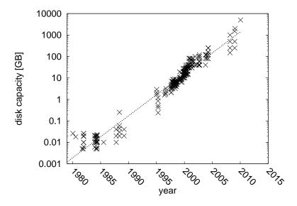
Figure A.2: Evolution de la capacité des disques dures dans le temps.
