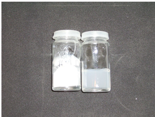
FIG. 4.32: Echantillons de BSA encapsulée dans la silice sol-gel. A gauche : poudre obtenue après lyophilisation, à droite : gel obtenu après l'encapsulation
