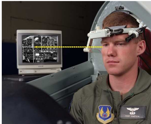
Figure 10. Dispositif d'Eye tracking de type EL-MAR
