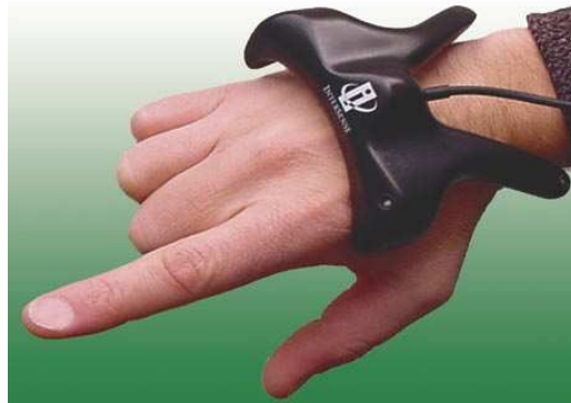
Figure 8. Le système de tracking inercial IS-900 MiniTrax d'Intersense
