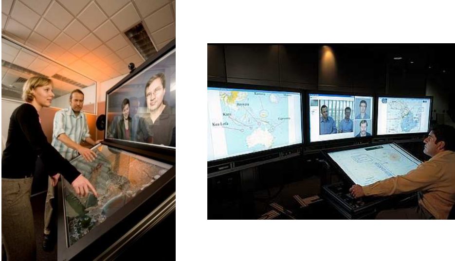
Figure 42. Configurations du Braccetto, à gauche configuration par défaut du Braccetto (configuration de type Workbench), à droite une autre configuration du Braccetto avec quatre écrans
