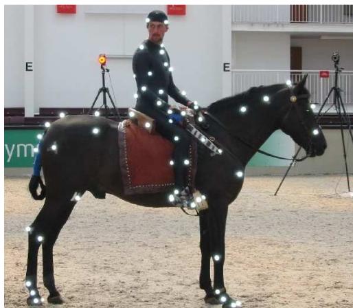
Figure 9. Un système optique de motion capture
