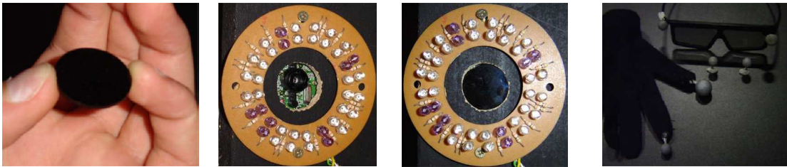
Figure 38. Matériel utilisé, filtres, Webcams modifiées, marqueurs
