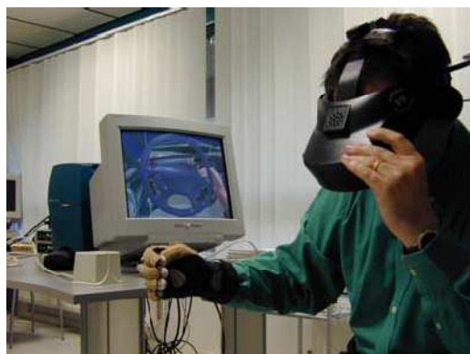
Figure 13. Modèle d'un visiocasque stéréoscopique
