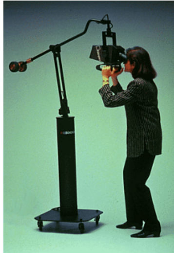
Figure 7. Système d'affichage de type BOOM utilisant le tracking mécanique
