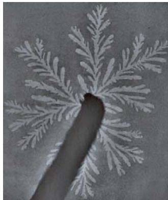
FIGURE 3.2 – Instabilité de Saffman-Taylor en cellule de Hele-Shaw : le fluide moins visqueux utilisé pour pousser le fluide plus visqueux digite selon une instabilité de longueur caractéristique déterminée par viscosités et tension de surface.
