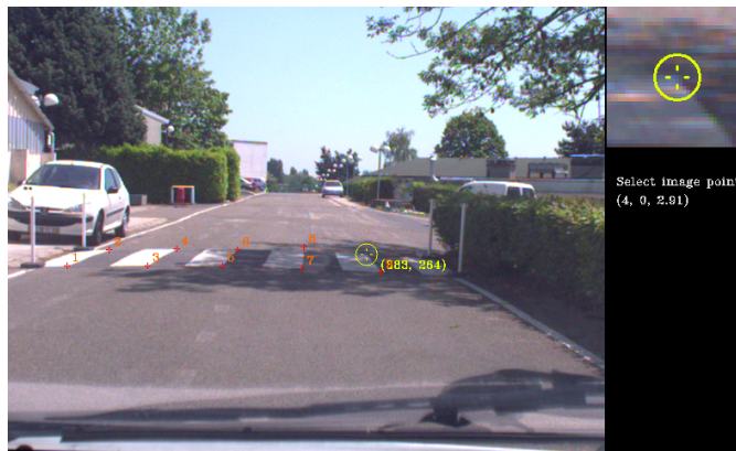
FIG. 5.2 – Sélection des points d'un amér contenu dans le plan de l'espace navigable, et dont les coordonnées 3-D sont connues, pour la calibration des paramètres extrinsèques de la caméra.
