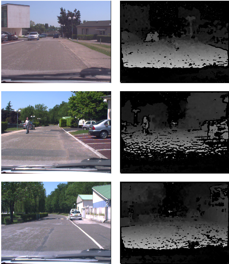
FIG. 6.2 – Carte des profondeurs relatives. Du plus clair au plus sombre, dans le sens des profondeurs croissantes (en noir, les profondeurs non estimées).
