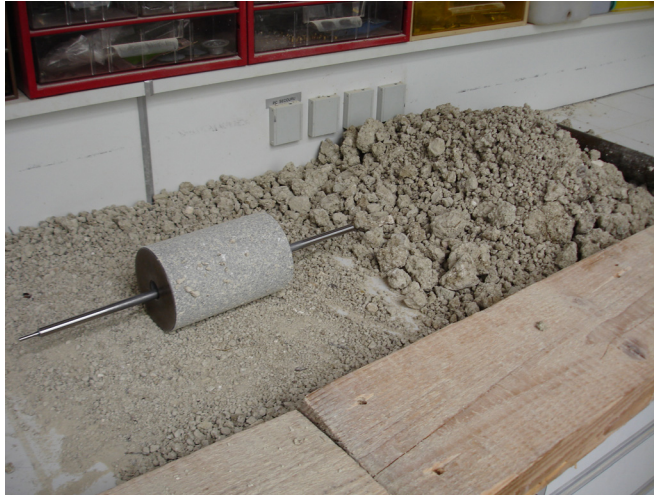
Figure 1.18 : Broyage du sol
