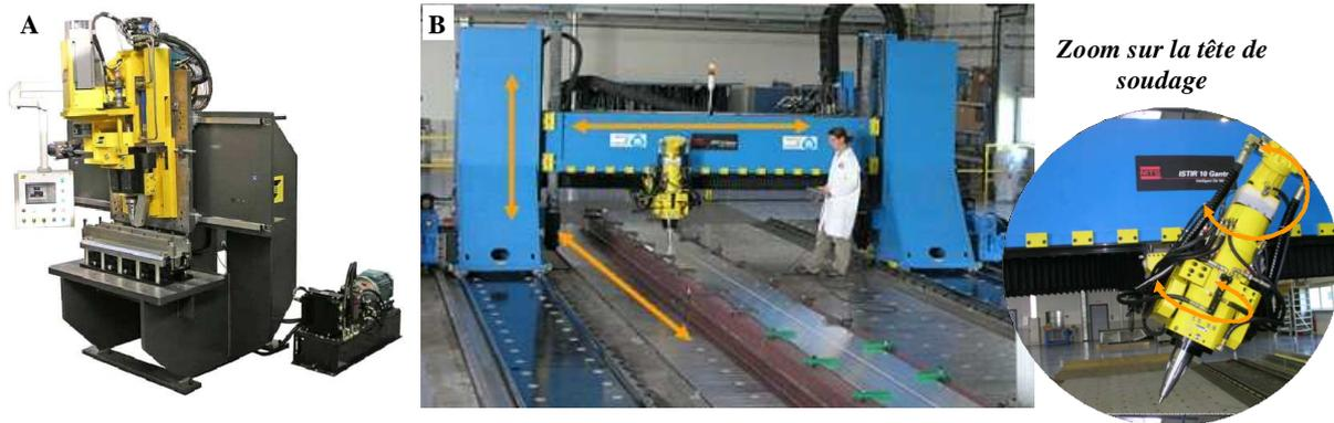
Figure 43: Exemple de machine dédiée au FSW. A- Machine ESAB Legio permettant de réaliser des soudures dans le plan (x,y). B- Machine de type portique cinq axes MTS
