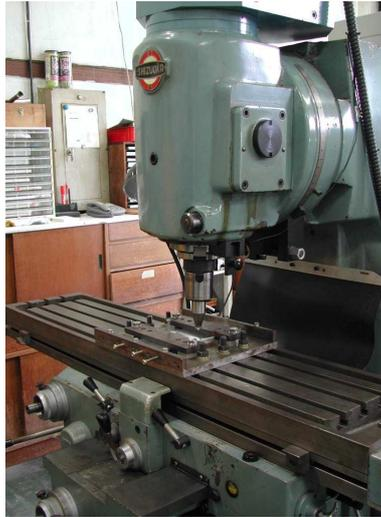
*Figure 42: Présentation d'une fraiseuse utilisée pour réaliser du FSW [BHA\*\*]*
