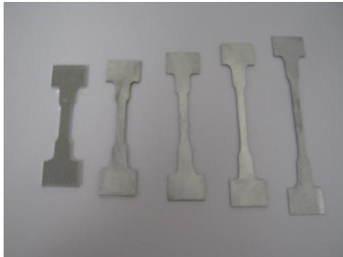
Figure C.2. Eprouvettes après déformation superplastique
