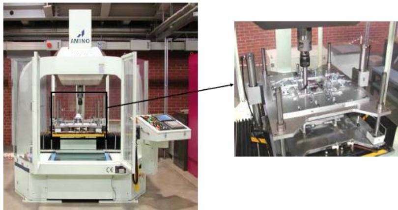
Figure 3.1. Formage avec une machine AMINO [Aza04]
