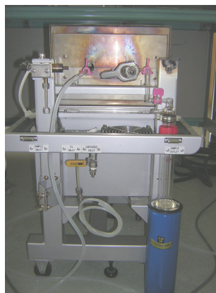
Figure III-5. Photographie du four utilisé pour la thermo-oxydation des échantillons d'huile
