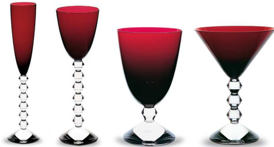
figure 2: Verres de couleur dite « Rubis » de la collection Véga chez Baccarat, couleur obtenue par incorporation de nanoparticules d'or dans la matrice vitreuse.
