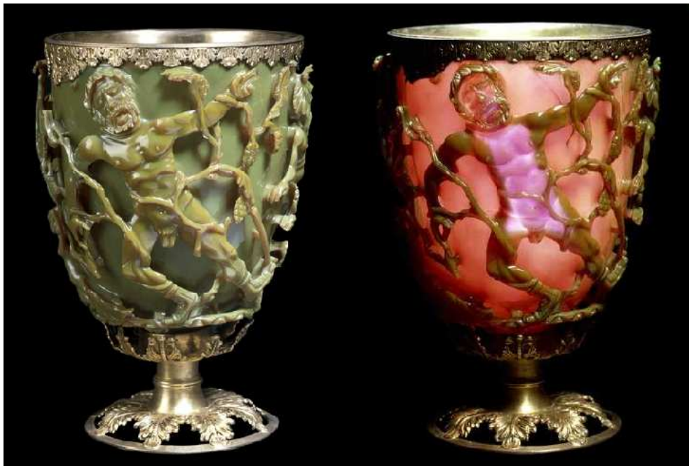
figure 1: Coupe de Lycurgus. A gauche éclairée en réflexion et à droite en transmission.
