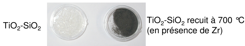
Figure 3.14 : Poudres de \text{TiO}_2 - \text{SiO}_2 avant et après traitement thermique à 700 °C, 2 h, en tube scellé en présence de zirconium métallique.
