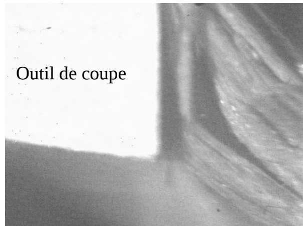
Figure 8. Délaminage intra-laminaire observé à l'aide d'une caméra vidéo rapide lors de la coupe orthogonale du matériau composite unidirectionnel à orientation -45^\circ (fibres carbone), selon Iliescu [Ili_08].
