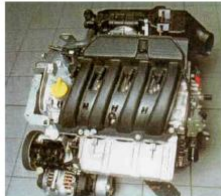
Prise d'air (PA+GF)
