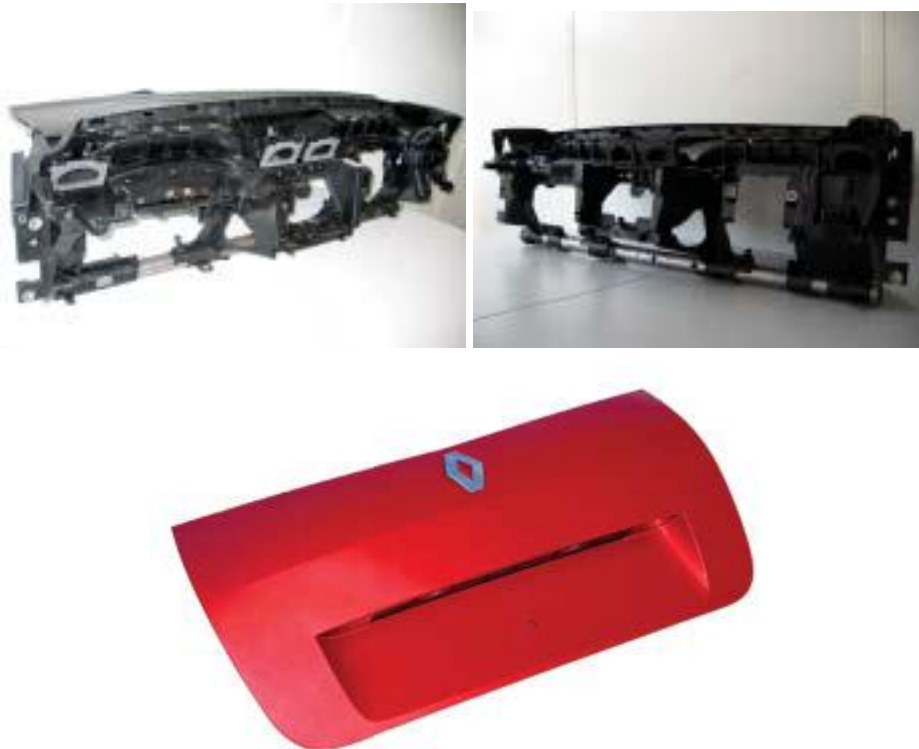
Figure I.7. Exemples de structures automobiles en PP-GFL, structures RENAULT.
