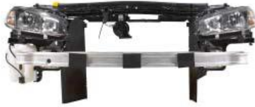
Figure I.4. Façade avant technique du véhicule RENAULT Mégane. Cette structure automobile est en polyamide et polypropylène, tous deux renforcés par des fibres de verre, d'après [3].
