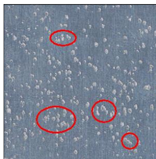
FIGURE 4.2 – Relevé d'un échantillon d'environ 10 \text{ cm}^2 sur une plaque montrant l'état de surface et le phénomène de coalescence des piqûres
