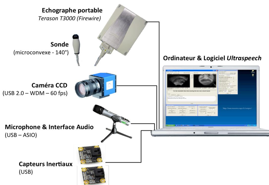
Figure 2.11 : Système d'acquisition multi-flux SA2 – Éléments matériels
