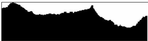
Fig. 5.16. Contour du profil obtenu par la méthode de Section Verticale sur l'éprouvette en acier inox 316L, (grossissement 50X)
