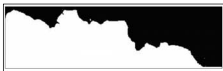
Fig.5.12. Conturul profilului obținut prin metoda Secționării Verticale pe epruveta din oțel XC65, după tratamentul termic de călire, (puterea de mărire la microscop: 400x)
