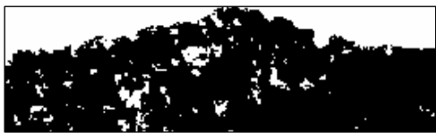
Fig. 5.18. Contour du profil obtenu par la méthode de Section Verticale sur l'éprouvette en acier inox 316L, (grossissement 100X)
