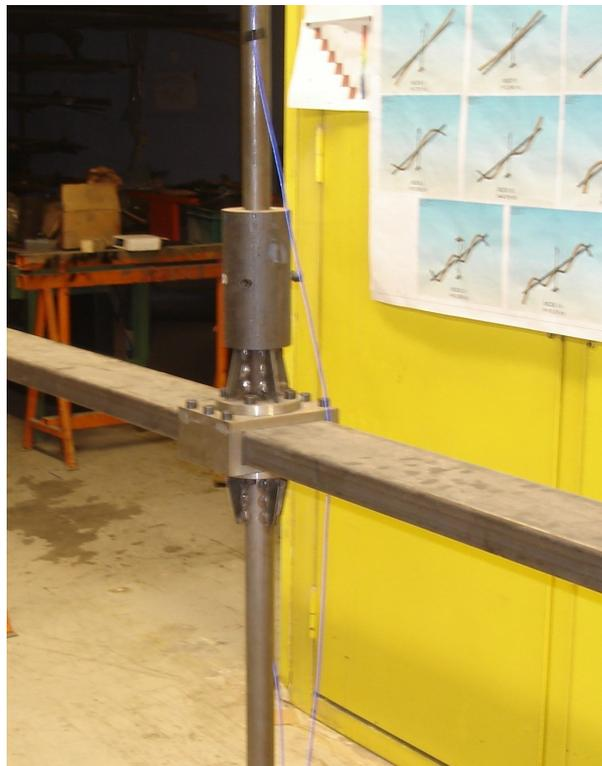
Fig. 7.2 – *Détail de l'encastrement central de la structure*
