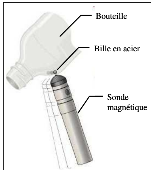
Fig. 3.40 - Principe de la mesure d'épaisseur
