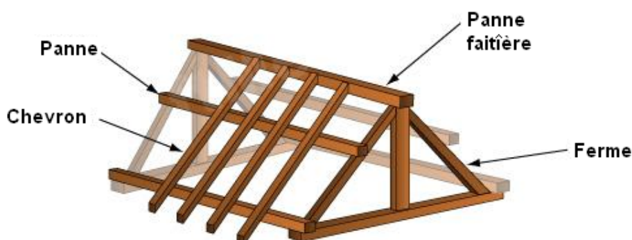
Figure 1.5 - Charpente traditionnelle pour comble aménagé
