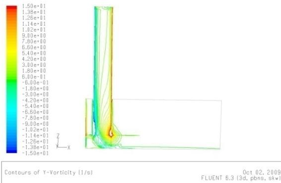
Fig.B.36.b: la vorticité dans le plan(x-z) pour  $\theta=0^\circ$
