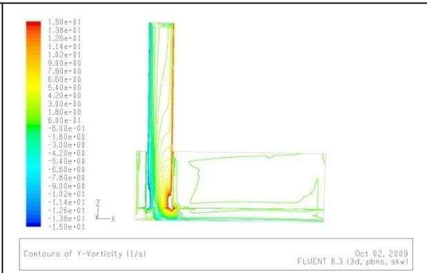
Fig.5.96.b: la vorticité dans le plan(x-z) pour  $b=2d$  et  $z=0,5d$
