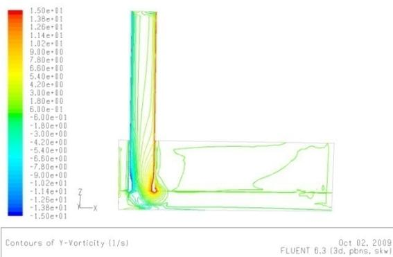
Fig.B.34.b: la vorticité dans le plan(x-z) pour  $\theta=30^\circ$
