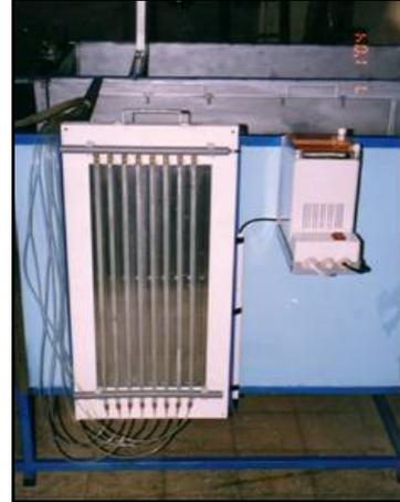
Figure.4.7 : multi manomètre pour lire la dépression
