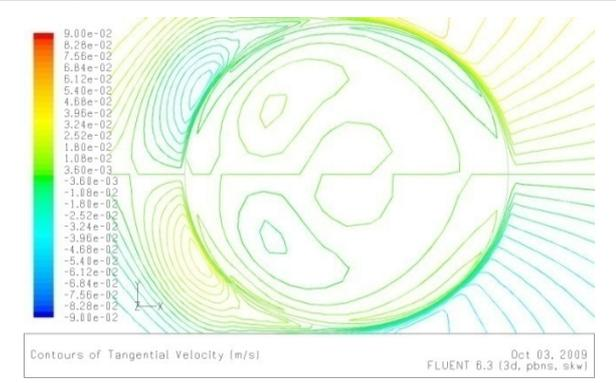
Fig.5.120.b : cas de  $b=2d$  -  $V_{tg}$  à  $Z=1,25d$
