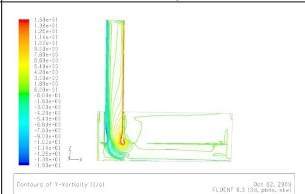
Fig.5.100.b: la vorticité dans le plan(x-z) pour  $b=2d$  et  $z=d$
