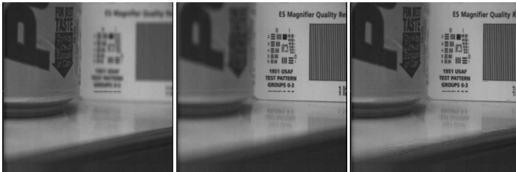
FIG. 6.15 – Focus sur le premier plan (à gauche). Focus sur l’arrière-plan (au milieu). Images fusionnées par ondelettes (à droite), le premier plan et l’arrière-plan sont nets simultanément.
