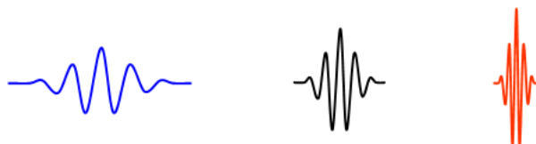
FIG. 6.3 – Trois ondelettes filles de Morlet : dilatée (gauche), échelle de base (milieu) et comprimée (droite).
