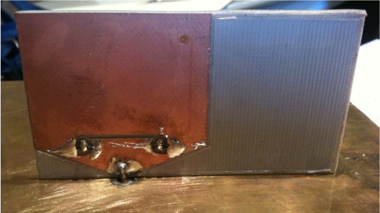
Fig. 4.20 : Photographie de l'antenne réalisée
