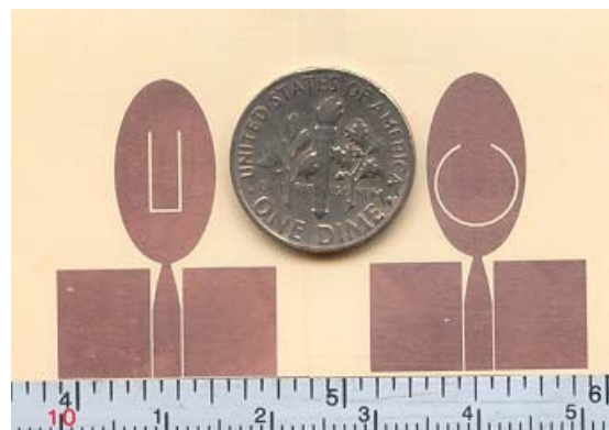
Fig. 2.11 : Exemple d'antenne UWB à réjection bande étroite par ajout de fente
