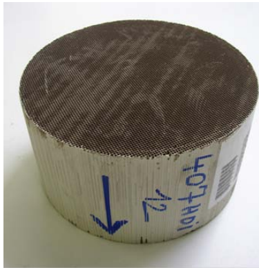
(a) DOC utilisé sur le modèle Peugeot 407 HDi FAP 2.0-L. 1.22-L / Ø 5.63 x 3 in / densité de canaux : 400 cpsi
