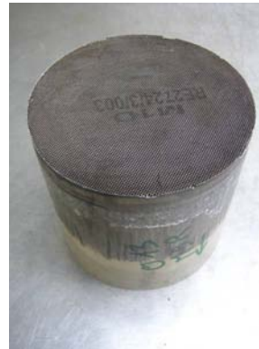
(b) DOC utilisé sur le modèle Renault M9R 2.0-L. 2.21-L / Ø 5.67 x 5.5 in / densité de canaux : 400 cpsi
