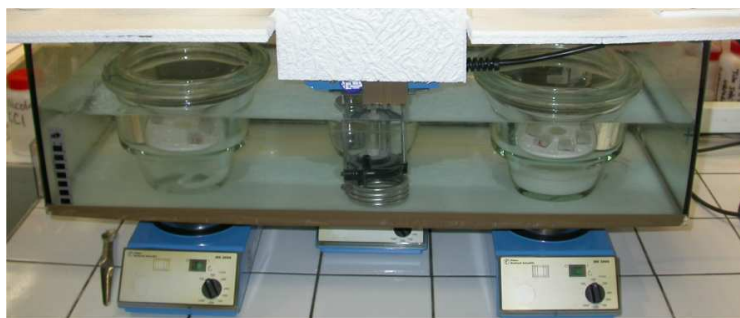
Figure 2.2.2 : Dispositif d'imposition de la succion par phase vapeur
