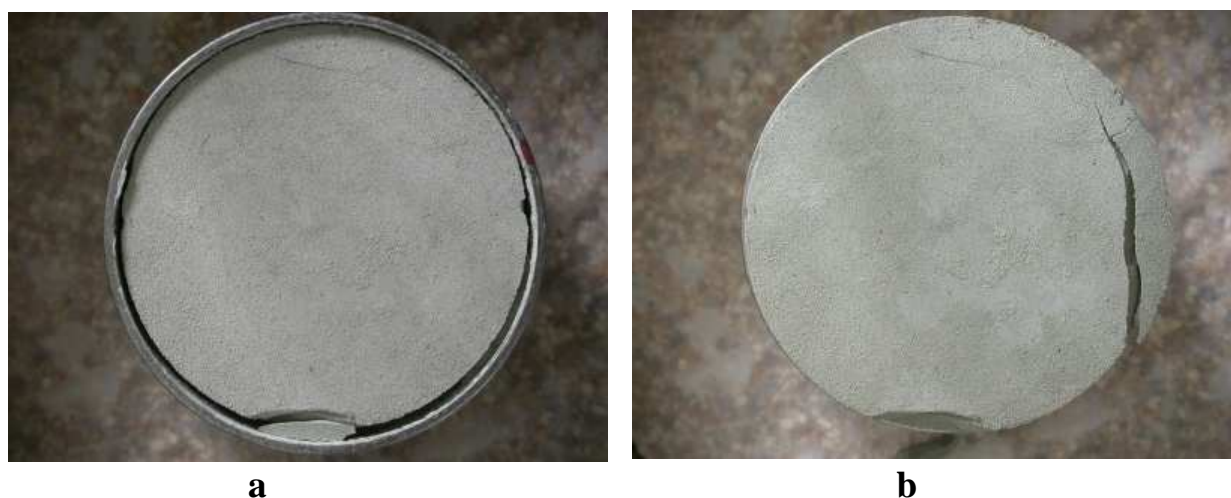
Figure 5.1.4 : Echantillon intact de Marne bleue d'Argenteuil : a) après séchage, b) après imbibition ( w > w_R )
