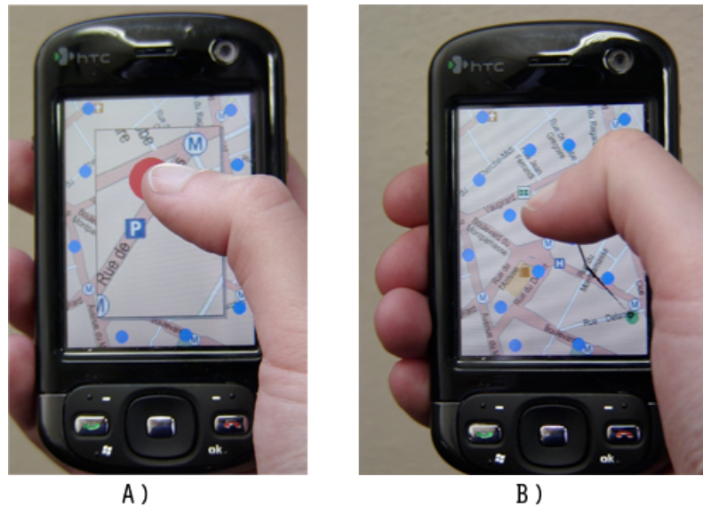
Figure 41. A) Avec TapTap les cibles sont assez larges pour éviter l'occultation ; B) MagStick évite l'occultation car le pouce s'éloigne de la cible au lieu de s'en rapprocher.
