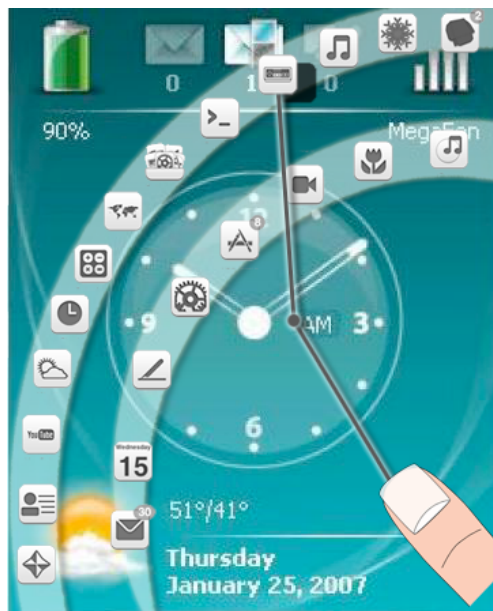
Figure 52. MagMenu est un menu circulaire basé sur l'utilisation de MagStick. Les items ne sont pas occultés par le pouce puisqu'il s'éloigne de ceux-ci au lieu de s'en rapprocher.
