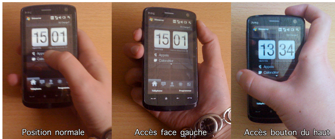
Figure 12. Changement de prise en main pour atteindre les boutons physiques du dispositif sur les cotés.
