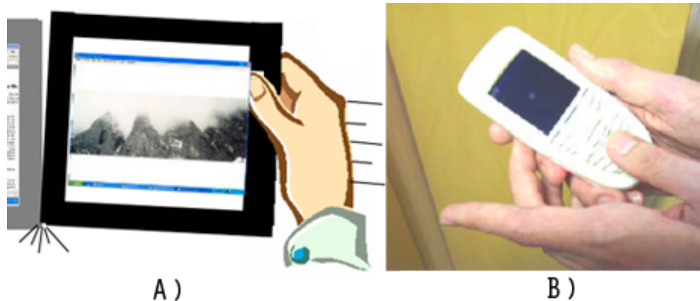
Figure 106. A) Deux écrans sont couplés en les choquant l'un contre l'autre ; B) l'utilisateur contrôle une bille sur l'écran en tapant sur les cotés du dispositif.
