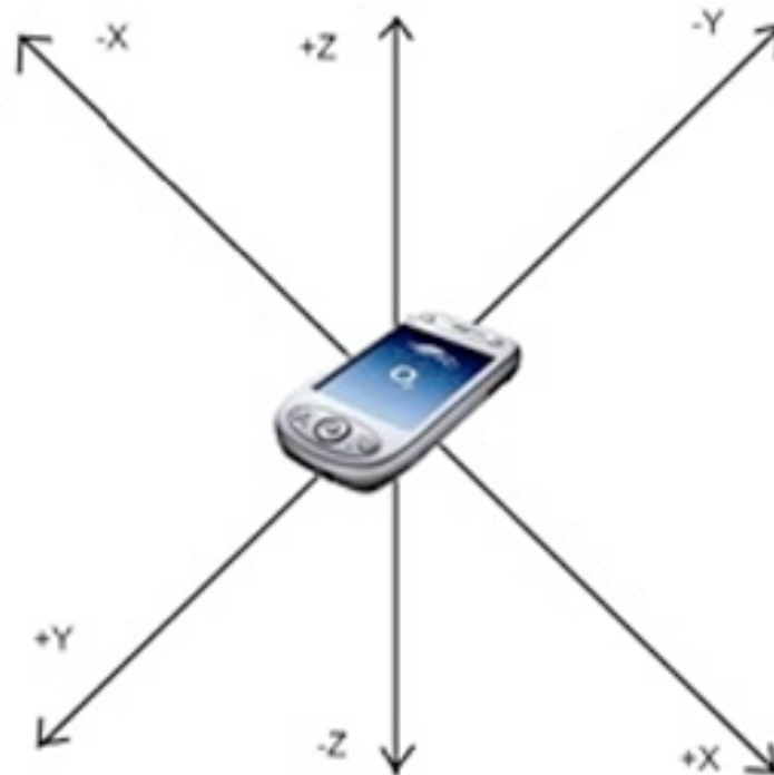
Figure 103. Les composantes du vecteur accélération d'un accéléromètre à trois axes dans le référentiel du dispositif mobile.
