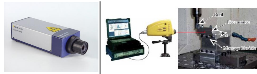
Figure I-16 : Vibromètre laser (modèle OFV-505) de la société Polytec (gauche) mis en œuvre pour mesure sur pièce flexible par Seguy [SEGUY2008a] (droite).
