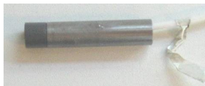
Figure II-8 : Capteur Kaman et sa protection.
