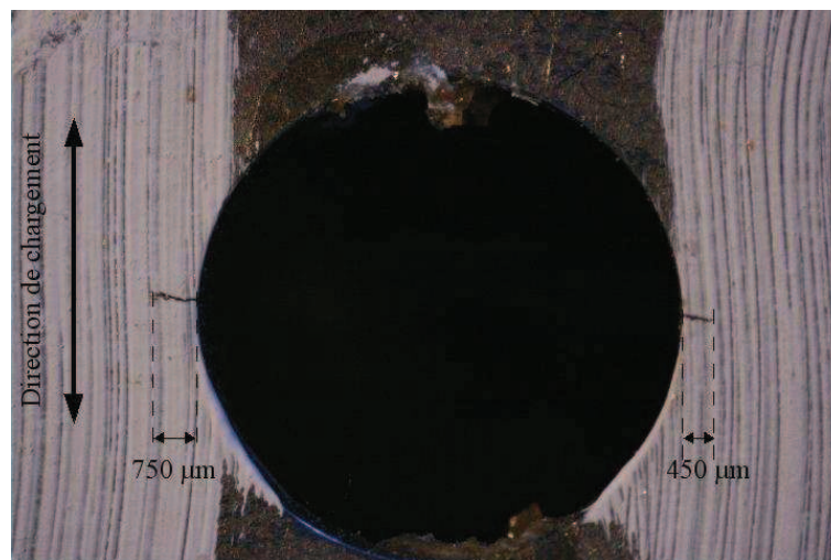
FIG. 3.7 – Fissures de fatigue détectées grâce au système de détection développé
