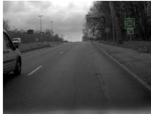
Figure 61 – Détection de panneau de limitation de vitesse
