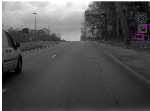
Figure 64 – Détection de rectangle
