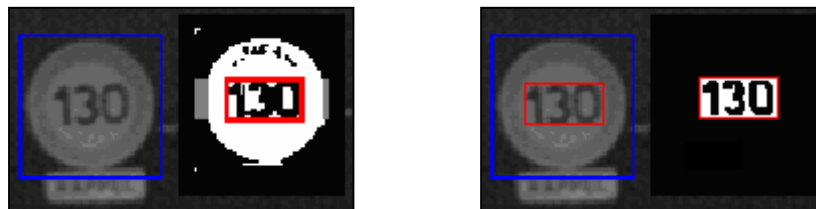
Figure 31 - Exemple d'amélioration apporté par la segmentation globale : Ancien résultat (à gauche) – Nouveau résultat (à droite)
