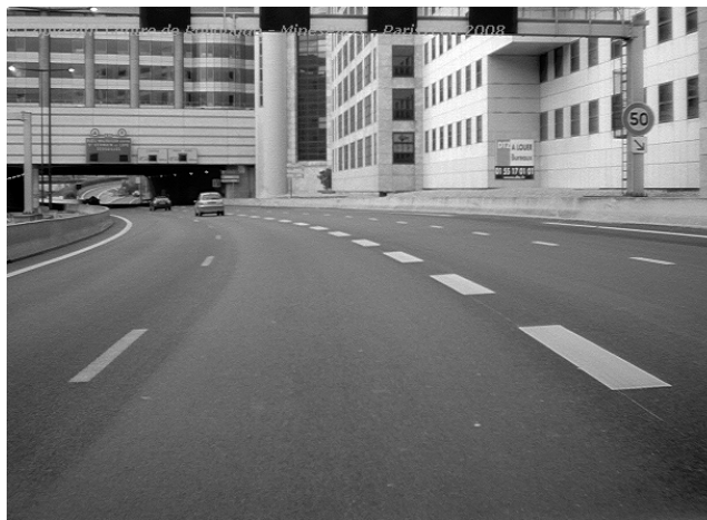
Figure 129 - Cas où il est nécessaire de coupler un système de détection des lignes de marquage au sol à un système de détection de véhicule pour créer un système, de plus haut niveau, d'évitement de collision
