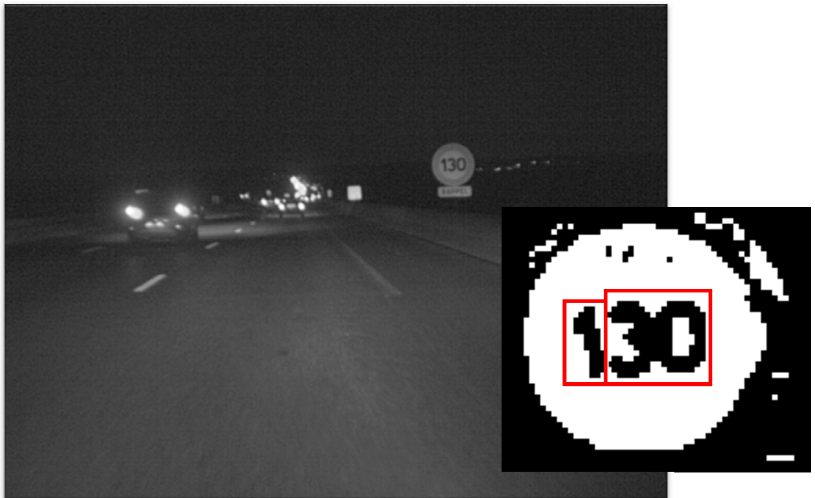
Figure 15 - Exemple de cas où la segmentation n'est pas correcte
