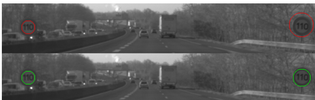
Figure 55 - Détection de cercle en haut - Résultat de la prédiction spatio-temporelle (en bas)
