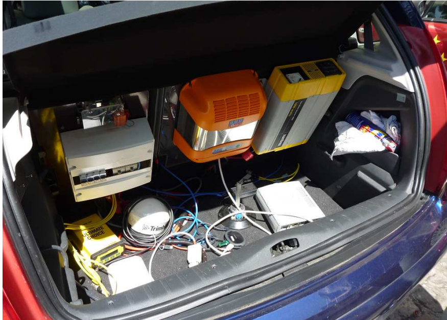
Figure 75 - Le coffre d'une C3 prototype et ses instruments
