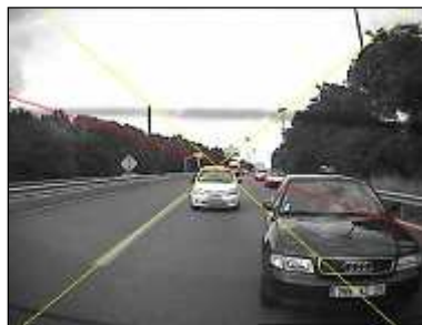
Figure 151 - Cas d'une ligne de marquage au sol occultée
