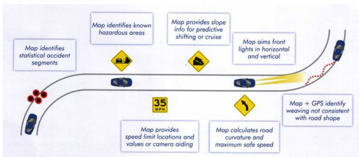
Figure 104 - Applications possibles aux systèmes ADAS d'un capteur cartographique (source NAVTEQ)
