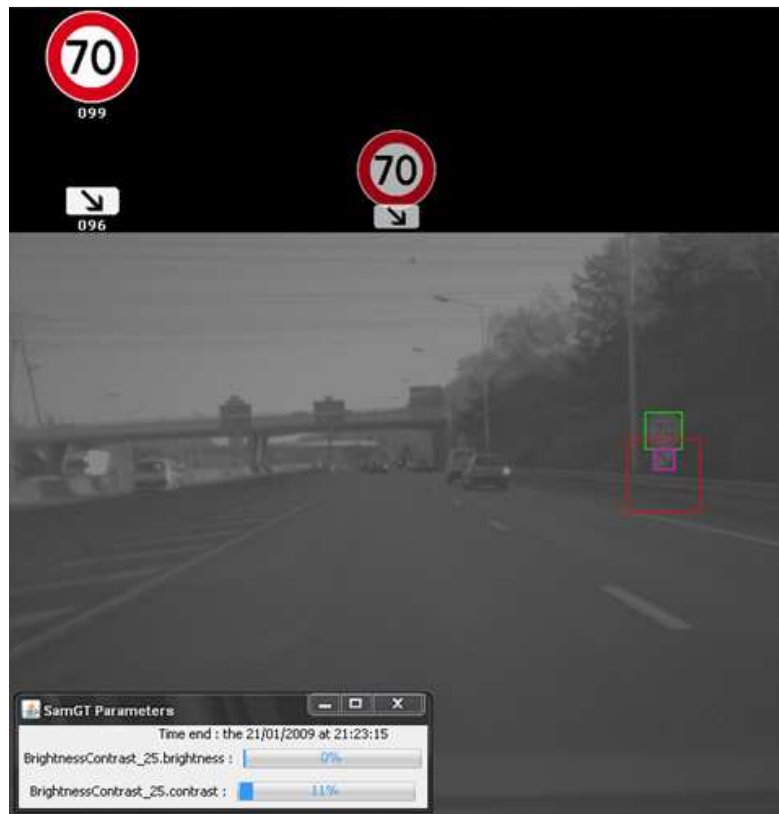
Figure 89 - Exemple d'évaluation panneau et panonceau avec changement automatisé de contraste / luminosité
