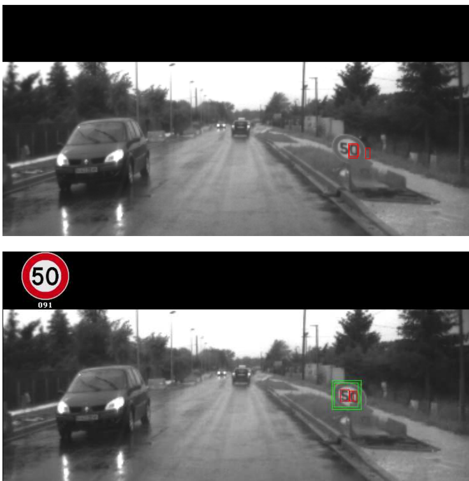
Figure 85 - Exemple de l'apport de l'algorithme de segmentation globale (en bas) face à l'algorithme initial (en haut) – Cas d'un panneau temporaire mal incliné
