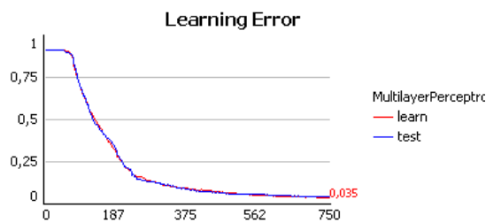
Figure 208 - Graphe d'apprentissage d'un Perceptron Multicouches à 31 neurones sur la couche cachée sur la base de chiffres
