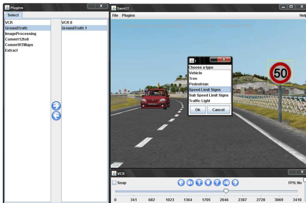
Figure 178 - Création d'une vérité terrain sous SamGT
